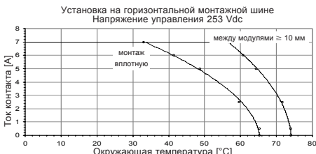
Установка на горизонтальной монтажной шине Напряжение управления 253 Vdc WRS 2 115 VDC/ 230 VAC • 8418260000
