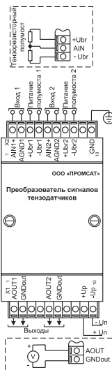
Схема подключения преобразователя PSA-01.08.12.XXXX.XX
