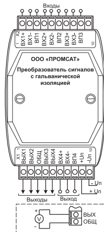
Схема подключения преобразователя PSA-01.05.14.XX.XX
