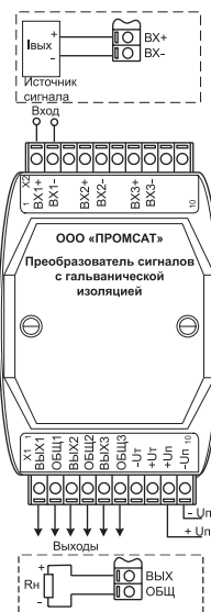
Схема подключения растроителя токов PSA-01.02.33.XX.XX
